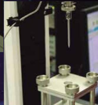
**Pinchazo o punción:** Resistencia del guante a la penetración de un punson neumático expresado en una escala de 1 al 4.
