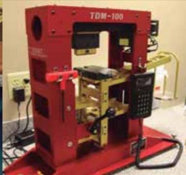
**Corte:** Resistencia del guante al contacto con una superficie filosa a distintos niveles de presión expresados en una escala del 1 al 5.
