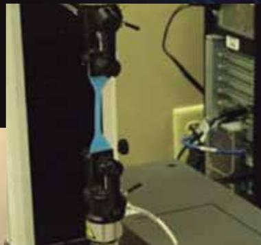
**Desgarro:** Resistencia del guante a la tracción ejercida, expresada en una escala del 1 al 4.
