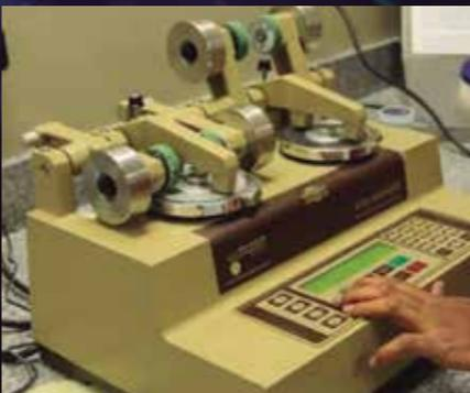
**Abrasión:** Resistencia al roce sufrido por el guante con distintos tipos de superficie expresados en una escala del 1 al 4.
